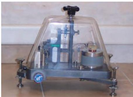
Sismomètre courte période vertical, conçu et fabriqué au CEA, utilisé à la station sismologique de Monaco de 1980 à 1990.
