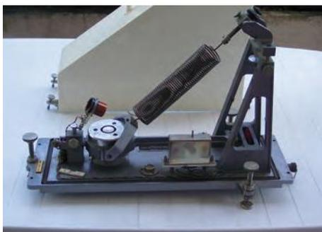
Sismomètre vertical « Wiechert ». Ce type d'appareil équipait les observatoires sismologiques jusque dans les années 1970. Il a été installé à Monaco, au moment de la création de l'Observatoire de Monaco.
