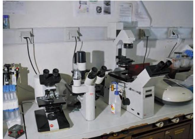
L'observation microscopique tient une large part dans l'étude des coraux. Celle-ci peut-être effectuée à l'aide de microscope optique (un microscope à fluorescence en haut, à droite). L'observation à l'aide d'un microscope électronique (réalisée au Centre Commun de Microscopie Appliquée de l'Université de Nice-Sophia Antipolis) permet l'analyse au niveau micrométrique (images de squelettes coralliens en microscopie électronique à balayage).
