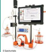
La filtration à flux tangentiel est une technique qui permet de filtrer des solutions en utilisant des membranes disposées perpendiculairement flux généré lui-même par une pompe péristaltique. Contrairement à la filtration dite "frontale", très majoritairement utilisée dans les laboratoires de recherche. le flux tangentiel réduit considérablement le risque de colmatage des membranes de filtration.
