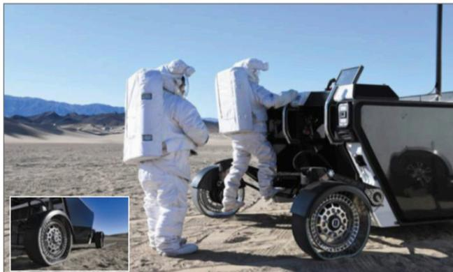
La roue hyper-déformable équipera le rover FLEX de Venturi Astrolab, dont l'envoi sur la Lune est programmé en 2026. (Photos Groupe Venturi)
