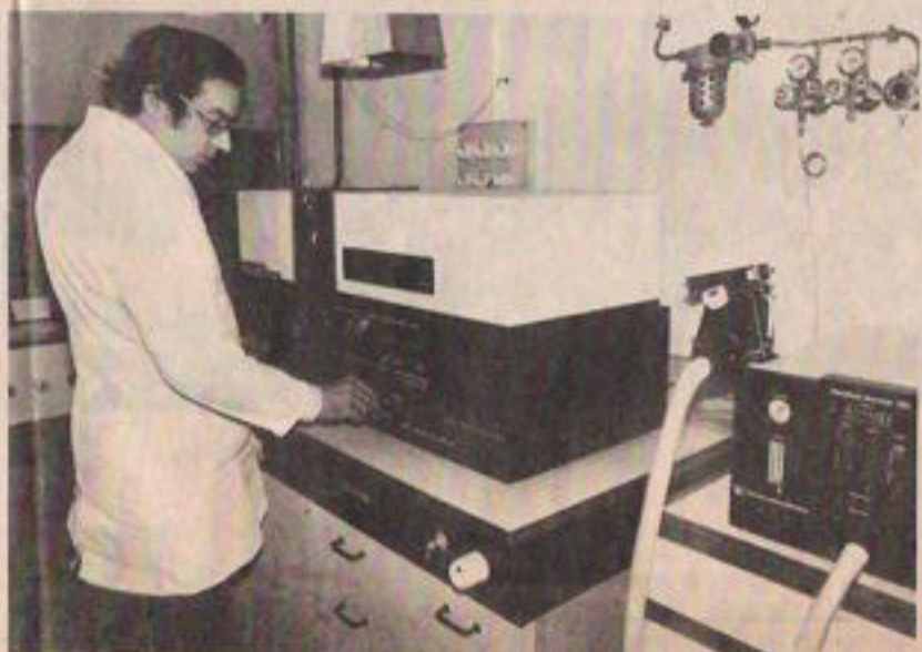
Pour le dosage des métaux lourds, M. Véglià utilise un spectrophotomètre.
